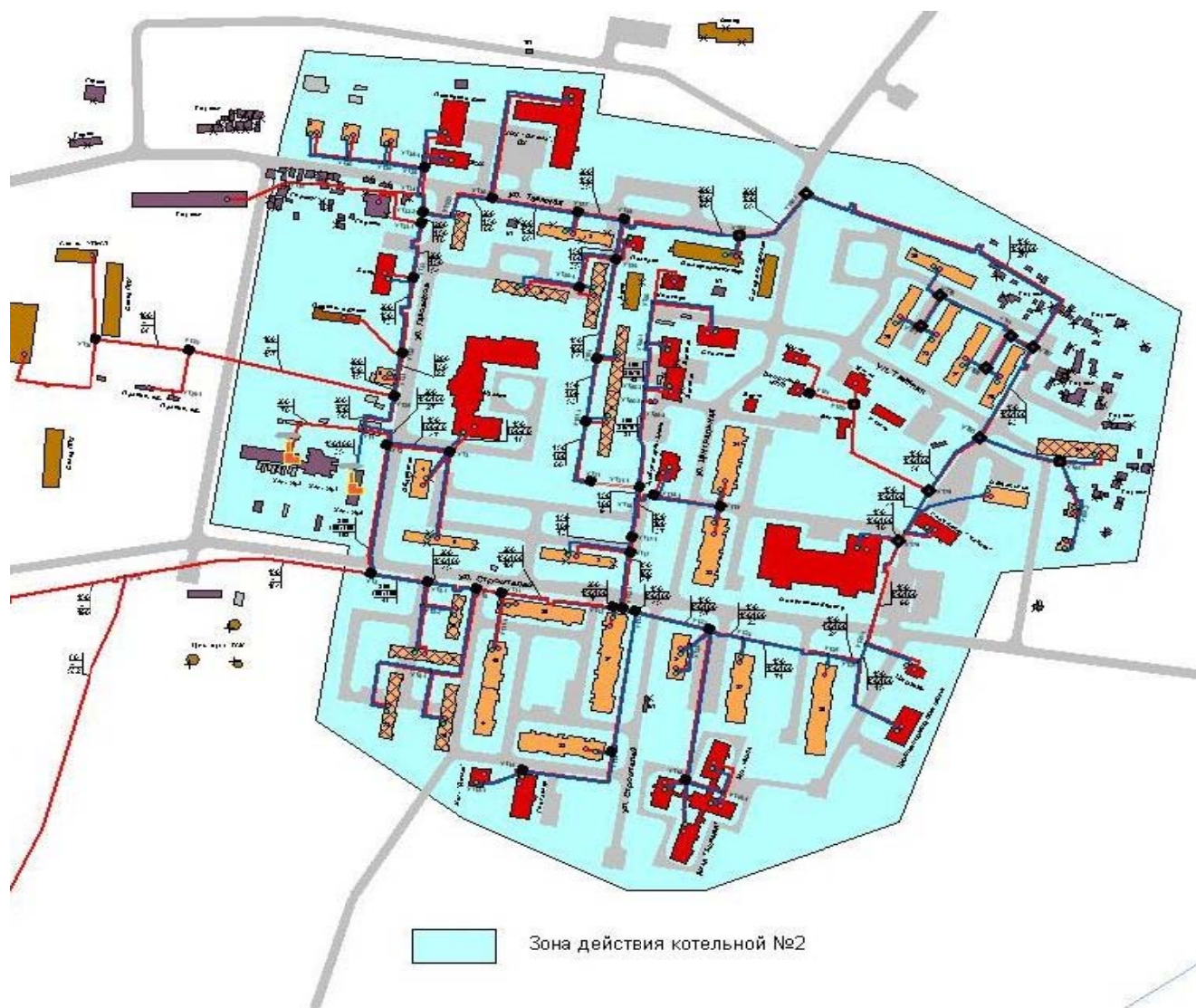
Рис. 2.2. Зона действия котельной №2
